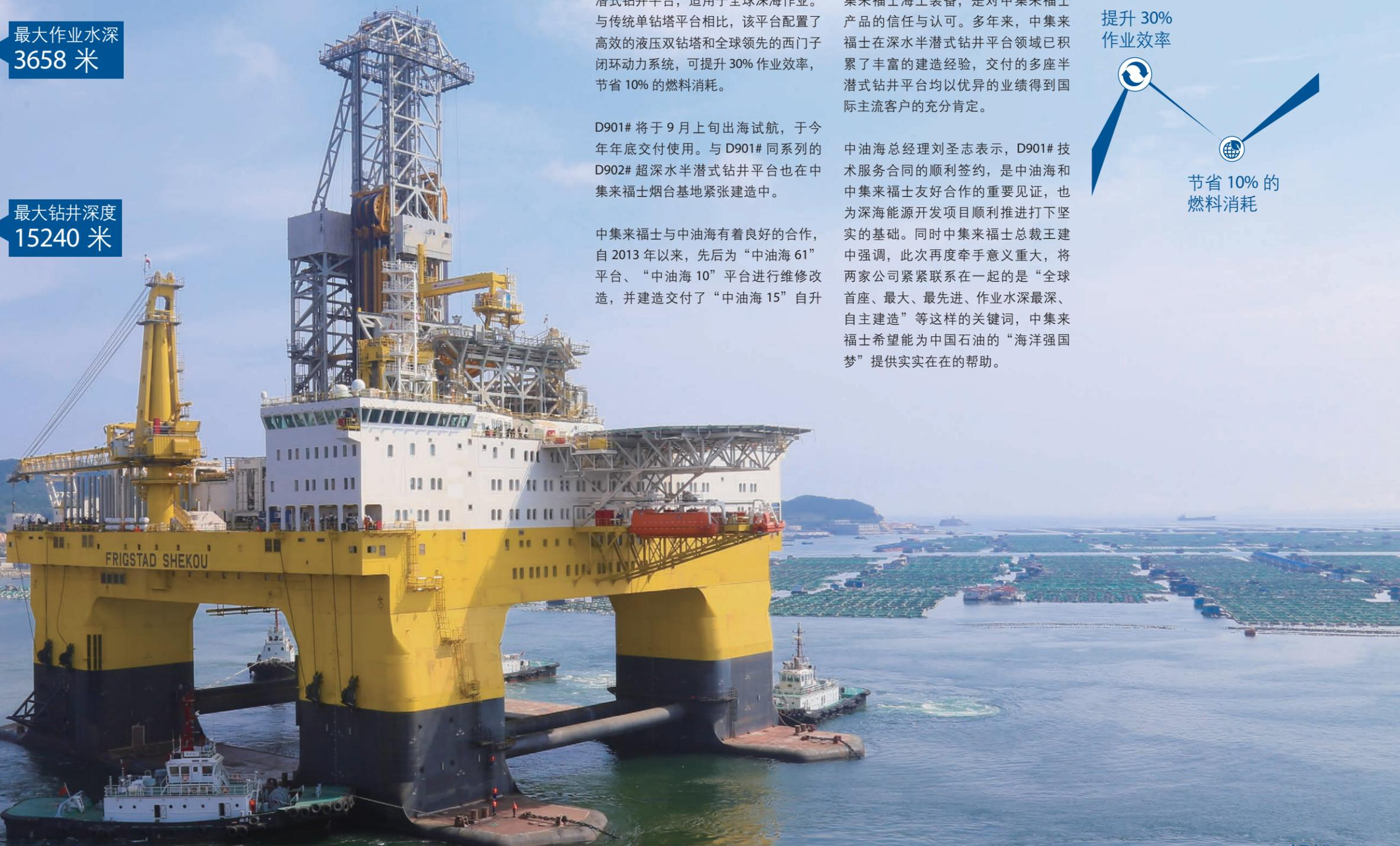
目前全球作业水深、钻井深度最深的半潜式钻井平台，适用于全球深海作业。与传统单钻塔平台相比，该平台配置了高效的液压双钻塔和全球领先的西门子闭环动力系统，可提升30%作业效率，节省10%的燃料消耗。
