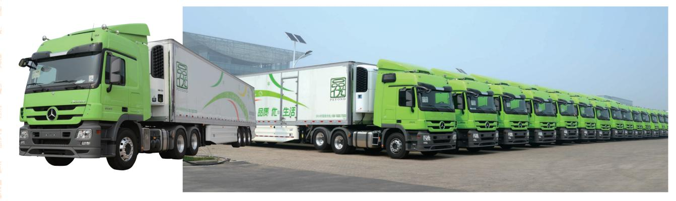
用高强度覆膜镀锌板或铝板作的厢体外板、热 塑内板、环保发泡剂、密封胶等环保材料,率 先达到了"无味、耐腐蚀"的食品级安全水准; 三是智能化方面,融合了智能感应 LED 灯、 智能温控风扇、智能温度监测等先进智能技术
